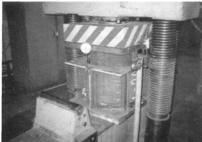
Рисунок 13. Испытание песчаного домкрата в лаборатории БИТУ
